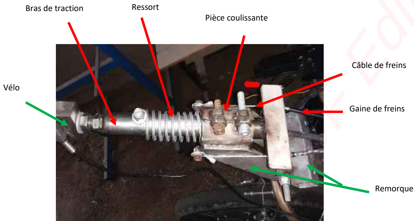
Figure 5 - Bras de traction et système de frein des systèmes de Veloma (ressource © Veloma)
